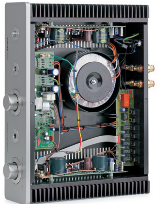
Ganz klassisch: der Aufbau des A21 SE (unten) mit den kanalgetrennten Endstufensektionen und die große Platine des Phonoverstärkers PA-4 (links).
