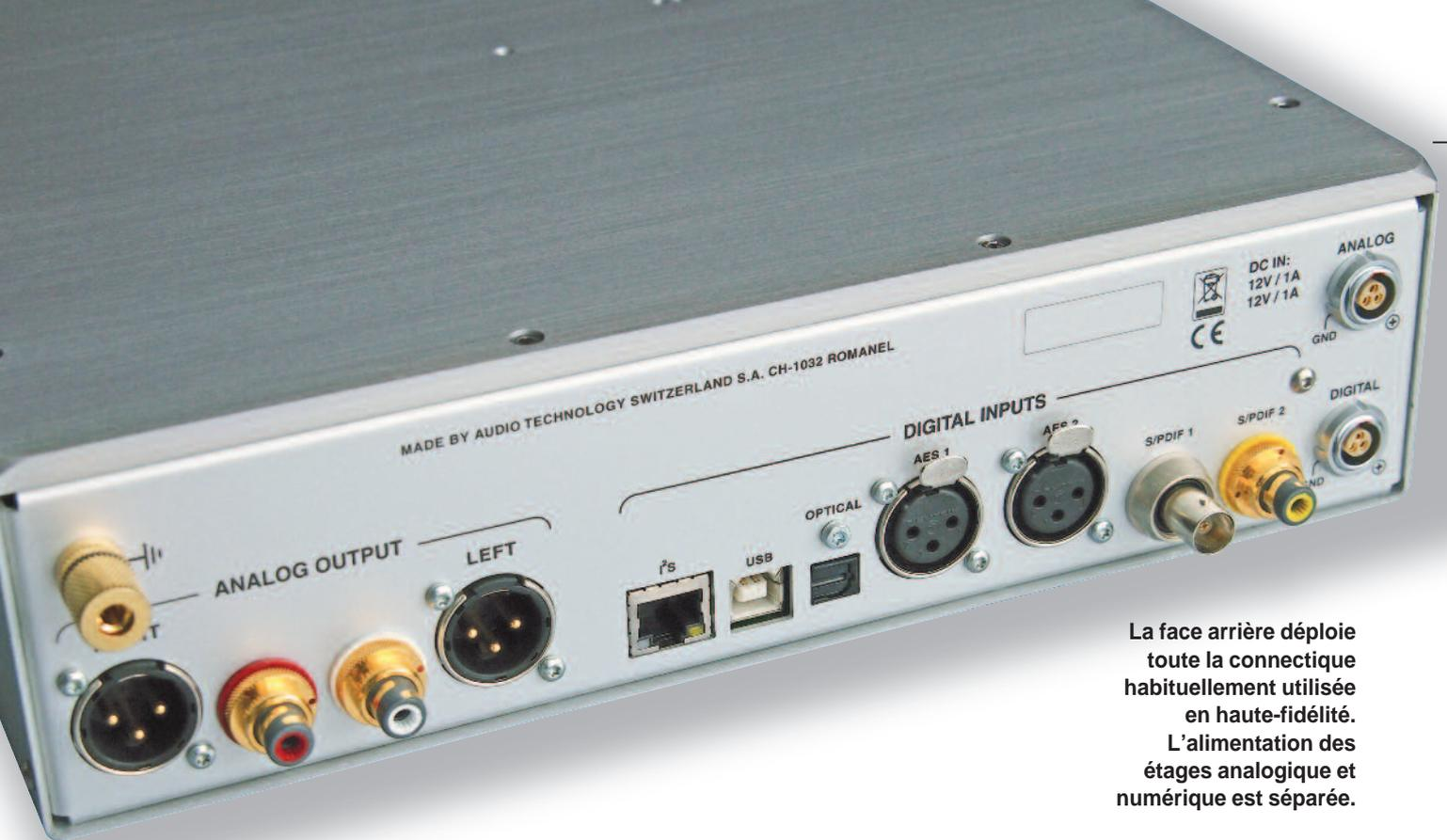
La face arrière déploie toute la connectique habituellement utilisée en haute-fidélité. L'alimentation des étages analogique et numérique est séparée.
