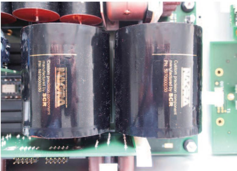
En haut, vue de la carte de gestion de la face avant et des condensateurs de liaison cathodique en sortie d'un canal. Au centre, l'étage buffer symétrique avec ses condensateurs Elna. On aperçoit la double triode dans son enveloppe de mumétal et les deux transformateurs de liaison. En bas, les deux condensateurs de découplage de l'alimentation HT.
